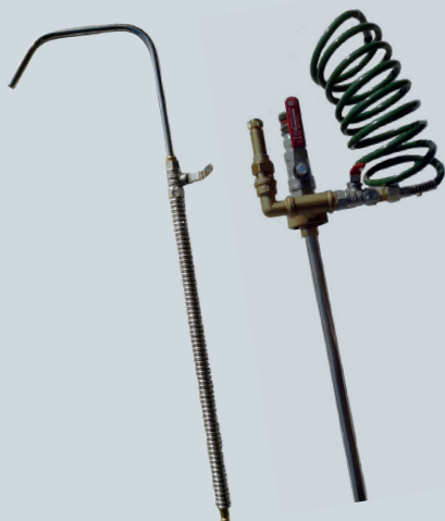
Přečerpávací zařízení na tlakový vzduch
